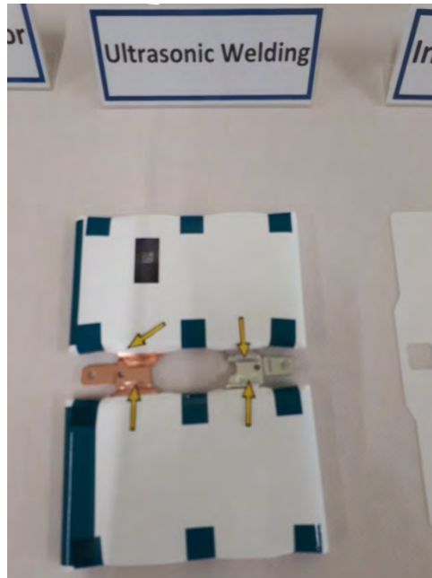
Kész, SFL réteggel bevont, fülhegesztett jelly roll
